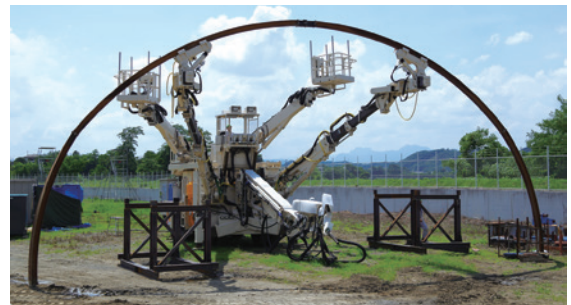
鋼製支保工建込みロボット全景
