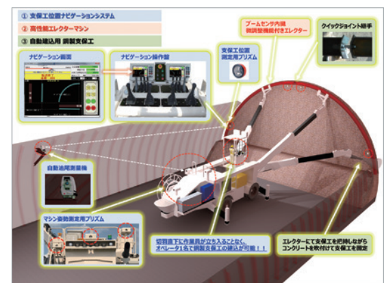
鋼製支保工建込みロボット概念図
