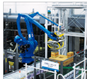
ケース自動ピッキングシステム
