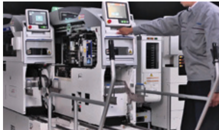
写真1 XYロボットモジュール交換
