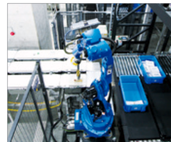
ピース用画像処理画面とピース自動ピッキングシステム
