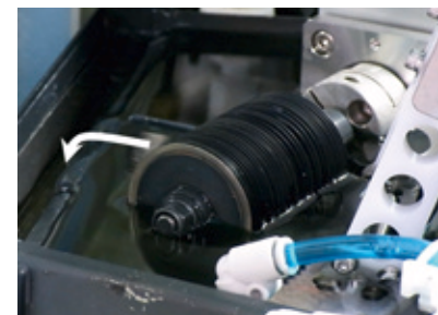
図3 破れた切片は矢印の方向に瞬時に流れ出る
