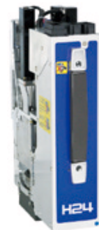
図4 新開発ヘッドH24 (ヘッド重量 2.5kg)
