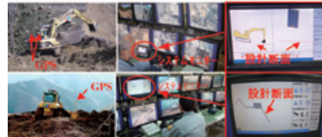
上段：油圧ショベル ガイダンスシステム 下段：ブルドーザ排土板 自動制御システム
