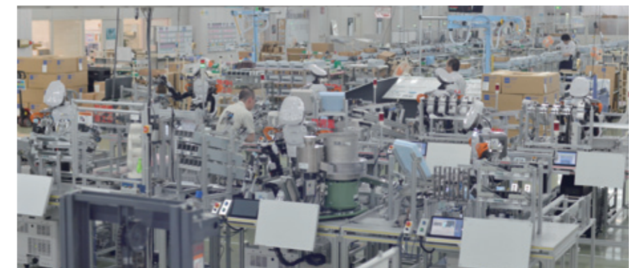
NEXTAGE7台によって構築された新しい組立ライン
