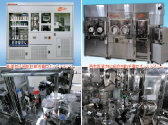
無菌を保証されたクリーンルームで熟練者が行なっている細胞の培養作業を、ロボットを使い自動化しました。創薬（新薬開発）用に多種類（最大29種類）の細胞を同時に培養できる細胞自動培養システムを販売中で、再生医療用に医療の品質基準（GMP）に準拠して培養が行える細胞自動培養システムを実証試験中です。
