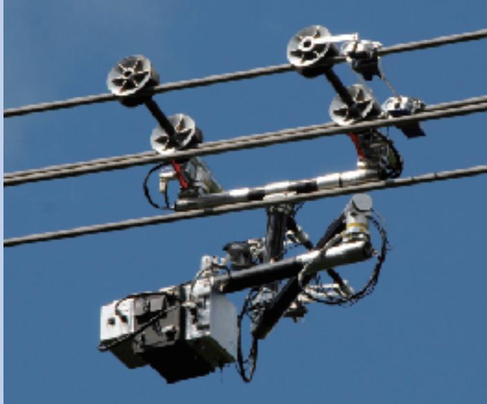
世界でも類を見ない、高圧送電線の活線点検ロボット「Expliner(エクスプライナー)」。このロボットは、遠隔操作でカメラを用いた正確な外観点検、50万V送電状態での作動、径間スペーサ等の障害物の乗越、人間と同等以上の点検性能保有、電線の点検履歴の蓄積、といった機能特徴を備えています。より安全な点検作業環境を確保でき、また、無停電での外観点検が可能となることから安定した電力供給を実現します。
