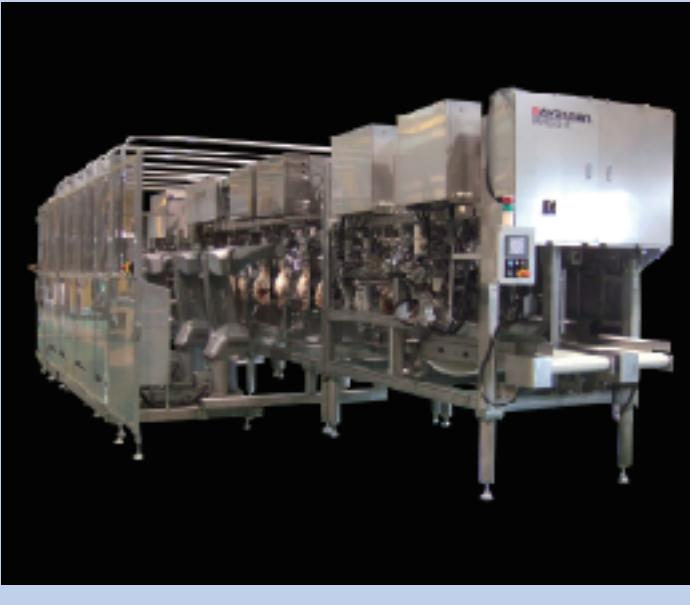
HAMDAS-Rは、骨がついた状態の豚もも肉から骨を取り除く処理(除骨)を自動で行うロボットです。
