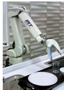
ロボットハンドへの搭載事例
