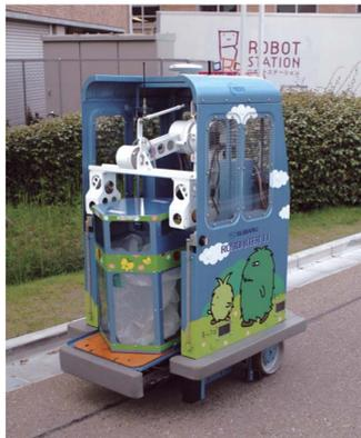
富士重工業(株)、NEDO ゴミ箱回収ロボット ロボハイター
