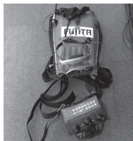
遠隔操縦ユニット
