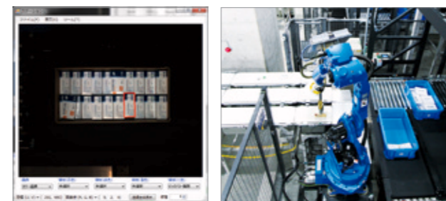
ピース用画像処理画面とピース自動ピッキングシステム
