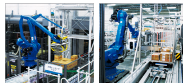
ケース自動ピッキングシステム
